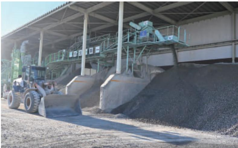
▲コンクリート廃材を砕いて再生砕石として製品化
